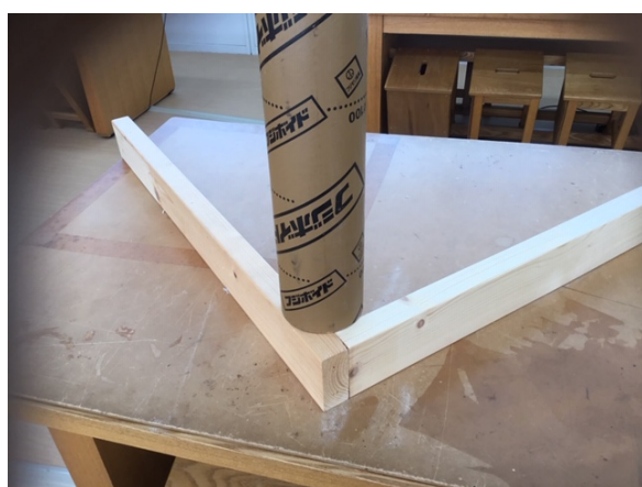
取り付けた2×4材にボイド管を刺す。
