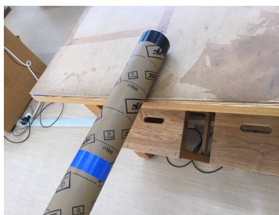
ボイド管の上端に黒のビニルテープを巻く。
