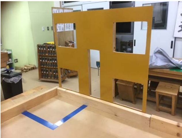
コート縁の2×4材にコーススレッド等で 取り付けます。
