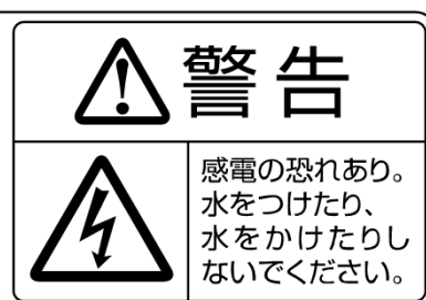
▲電気炊飯器の側面にある警告表示例
