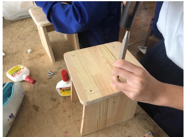
図9 隠し釘の作業②
