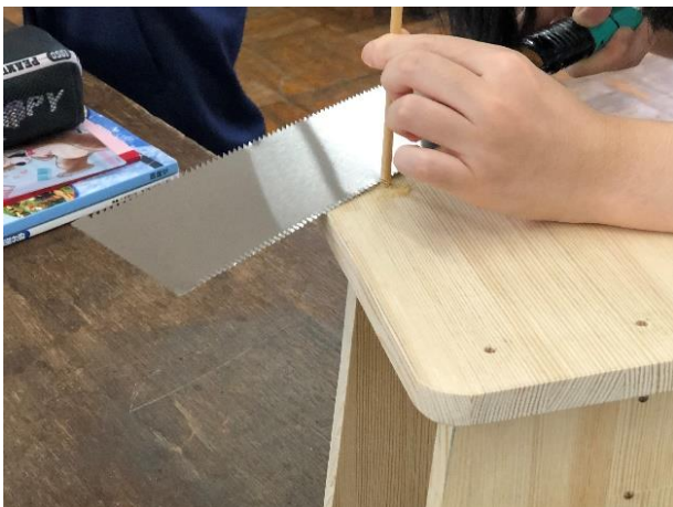
図8 隠し釘の作業①
