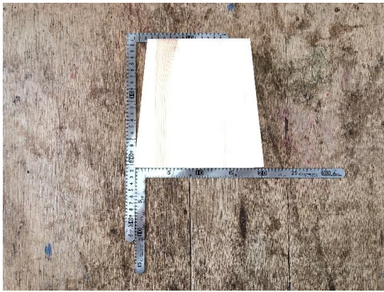
図6 さしがねを用いた平行の点検
