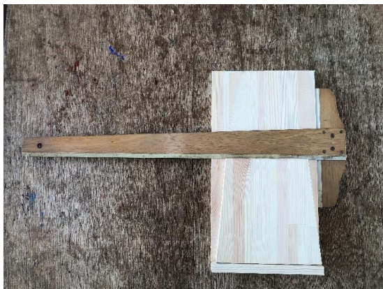
図7 T定規を用いた平行を点検する治具
