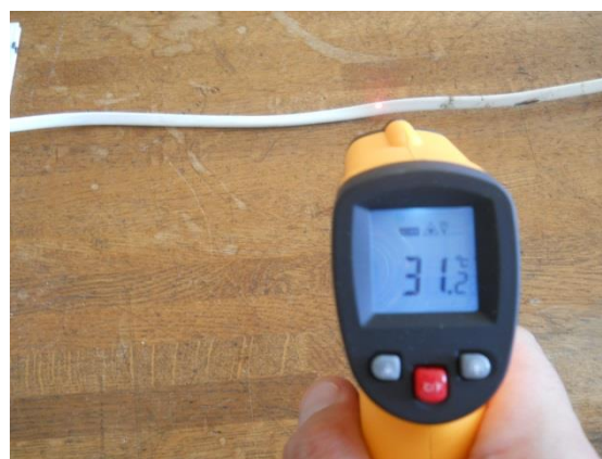
写真1 テーブルタップコードの温度測定
